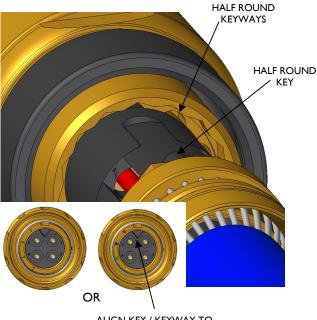
ALIGN KEY / KEYWAY TO REQUIRED POSITION
